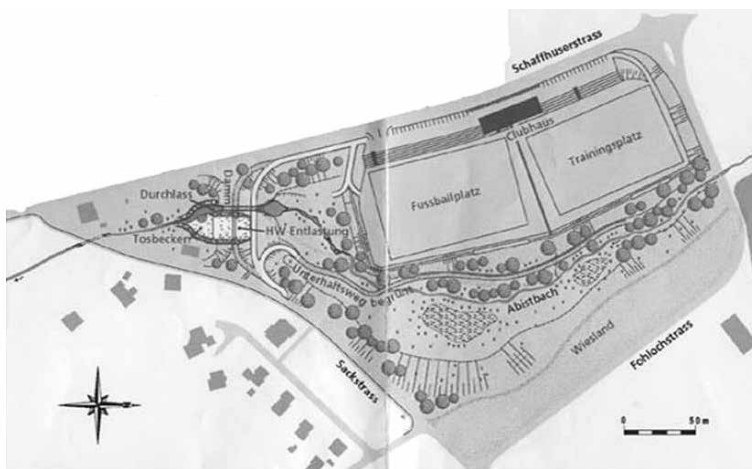
Fig. 4.24. Exemplo de uma bacia de retenção (Forloch Martalen, Zurique) cujo espaço de retenção corresponde às instalações de um clube de futebol (dois campos relvados com bancadas e instalações de apoio nos taludes marginais e no coroamento, respectivamente) e uma zona verde. Nenhum dos usos dentro da bacia é incompatível com uma submersão curta e durante todo o ano preenchem serviços sociais do maior interesse. A zona dos campos de futebol nunca é inundado por cheias com tempo de retorno (TR) de até 5 anos e o campo principal apenas será submerso por cheias com TR superior a 10 anos. A Bacia está dimensionada para cheias com TR até 200 anos.
