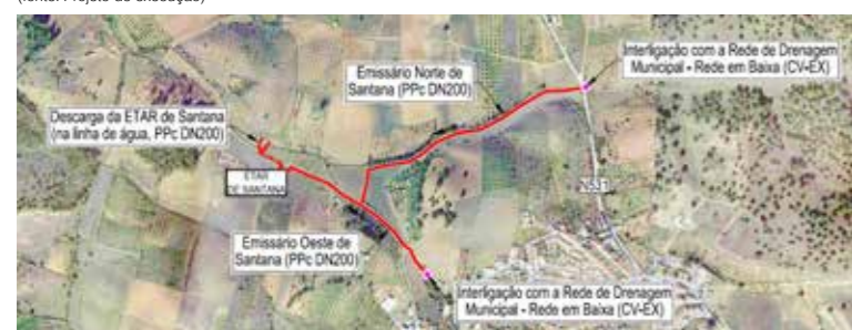
Figura 5. Subsistema de saneamento de Santana – infraestruturas (fonte: Projeto de execução)
