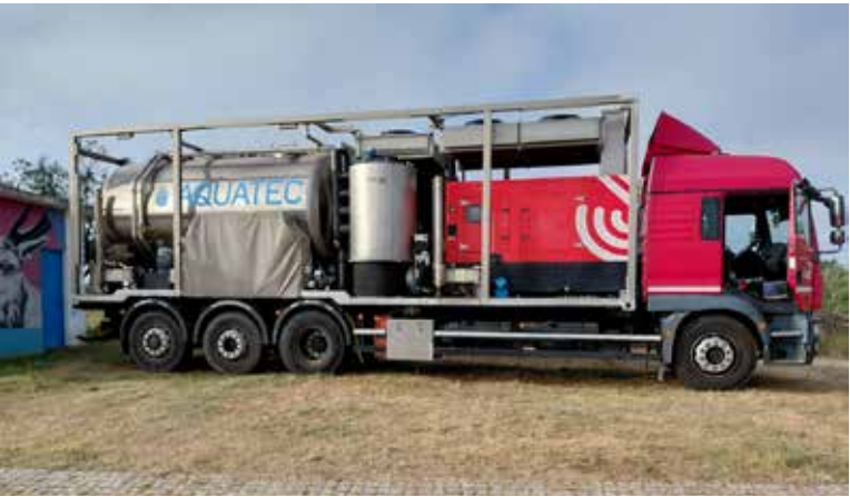
Figura 1. Viatura especializada para a limpeza de condutas com recurso à tecnologia Ice Scouring
