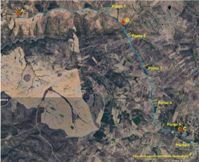
Figura 2. Pontos de injeção/descarga conduta adutora Malpica do Tejo
