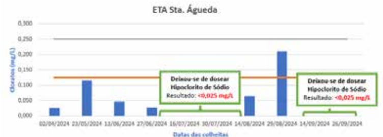
Figura 4 – Impacto da substituição de Hipoclorito de Sódio a 13% por cloro gasoso na ETA de Santa Águeda.
