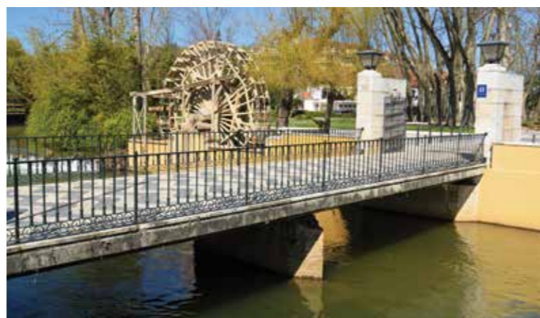
A nora, com cerca de 10 metros de diâmetro, foi feita em madeira de carvalho e de pinho. Este instrumento hidráulico, visto como um bom exemplo de arte e de engenho, carregava através do seu movimento rotativo, vários alcatruzes de barro, cada um com a capacidade de 5 litros de água.
