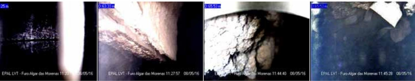
**Figura 2.16** Imagens capturadas da endoscopia do furo junto do algar das Morenas: NHE à profundidade de 60,25 m e cavidade cársica abaixo dos 63 m de profundidade
