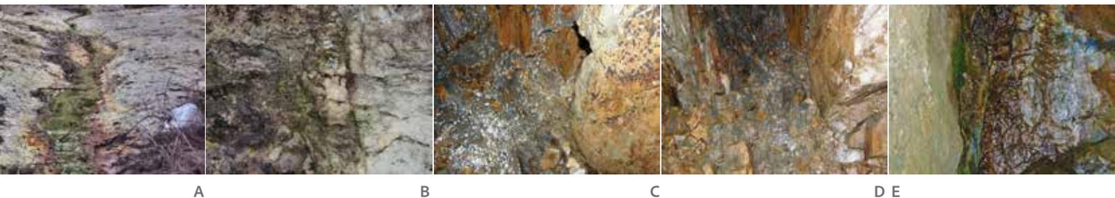
**Figura 2.2** Escoamentos subterrâneos em meios fraturados: granitos (A e B), xisto e grauvaques (C e D) e filão de quartzo (E) (fotos do autor)
