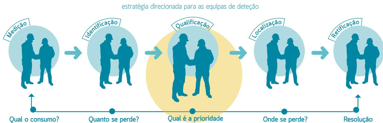
Figura 6.1 Definição da Estratégia de Deteção de Fugas
