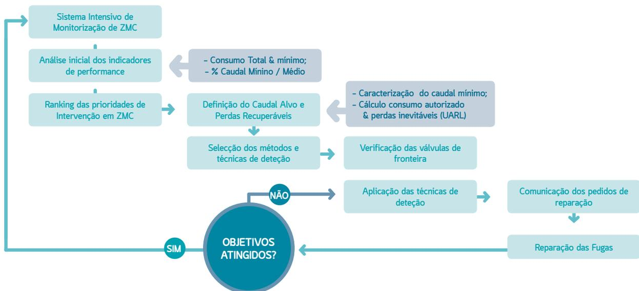
Figura 6.3 Integração da monitorização de rede com a deteção de fugas
