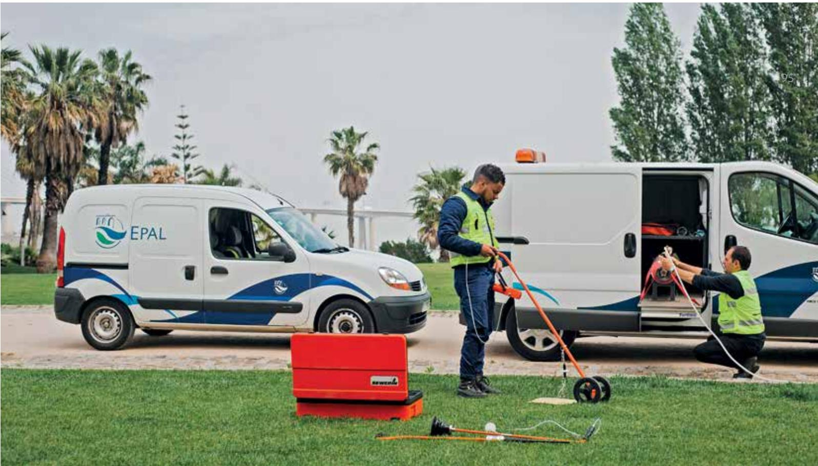
Figura 6.20 Método de injeção de gás
