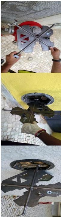
A EPAL projetou uma chave multifunções, manual, que conjuga várias ferramentas de forma ergonómica e não aleatória em função da configuração dos órgãos e acessórios e da sua disposição no terreno. Por conseguinte, reduz a mão-de-obra, primando a mobilidade devido ao seu porte, em relação ao conjunto das ferramentas existentes e capacidade de maneabilidade nos mais variados trabalhos aquando da necessidade premente de executar várias manobras sequenciais.
